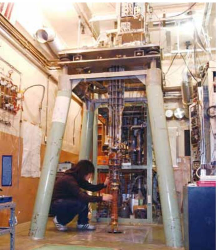
世界の数々所にしかない本専攻独自の2段断熱消磁装置。絶対温度0.01mK以下の温度をつくり、超流動の研究に使われる。
