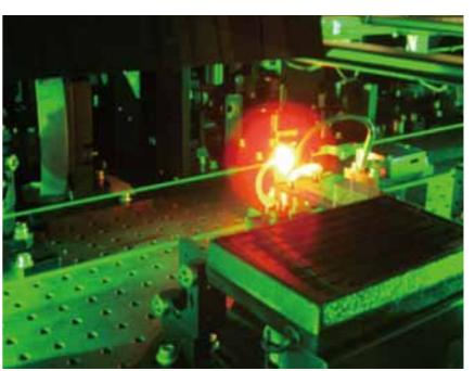
多価分子イオンを生成するのに必要な高強度超短パルスレーザー（30 fs, 15 mJ）の心臓部
