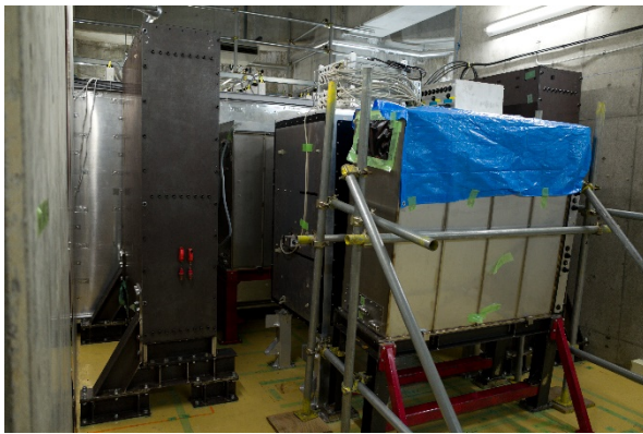
図 6: WAGASCI フルセットアップインストールの様子。手前は最初に建設された WAGASCI 水標的検出器，次にプラスチック標的検出器 (Proton Module)，その次に昨年度建設した 2 台目の WAGASCI 水標的検出器，その後ろにミュオン検出器が設置されている。両脇に立っているのが Side Muon Range Detector である。手前の WAGASCI モジュールは水の注入のために傾けてある。
