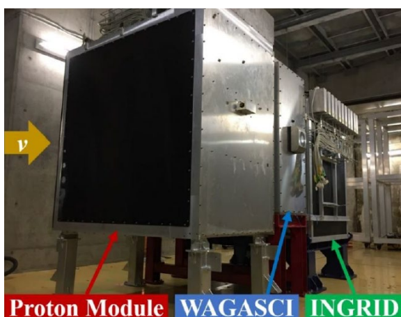
図 5: インストールされたニュートリノ検出器。手前は既存のプラスチック標的検出器 (Proton Module), 次に WAGASCI 水標的検出器, その後ろにミューオン検出器として使用する既存の鉄標的検出器 (INGRID)。
